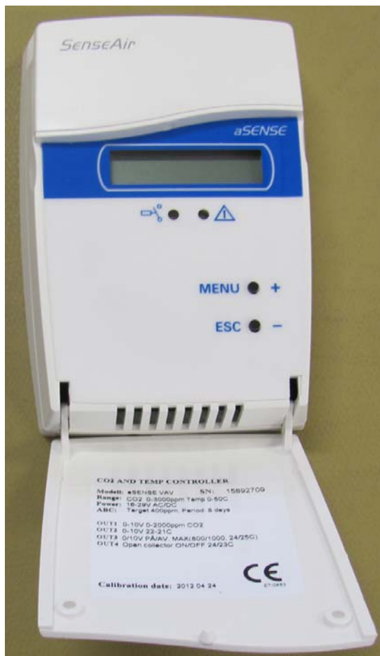
A-SENSE-V väggmodell med LCD-skärm och tryckknappar Etiketten med inställningar visas i locket
