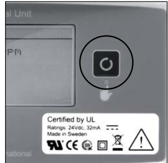
Knapp för ljud av/återställning
